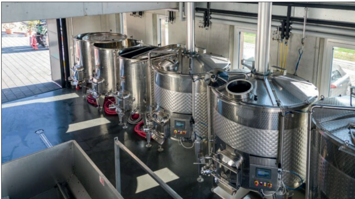
Die Gärung des Traubenmostes erfolgt in Stahltanks.
